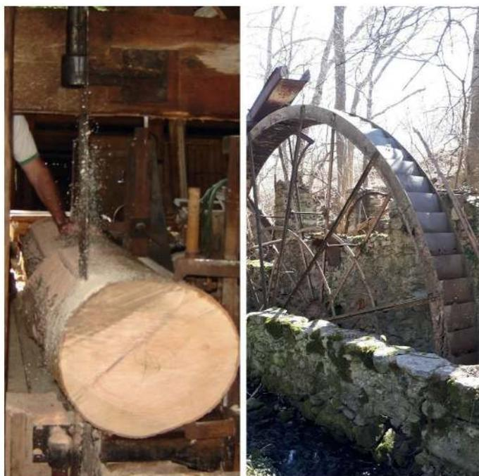
La roue à augets encore en place et le modèle de scie battante qu'elle faisait fonctionner.
